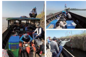
ミャンマー連邦共和国、シッタン川河口域において発生する Tidal Bore、および河口域における潮汐流の観測や河岸・底質材料調査の様子 (2019年2月)。河岸侵食は年間1000mにも及ぶところがあって、河岸侵食は農地ばかりでなく村の存亡にかかわる深刻な問題となっている。
