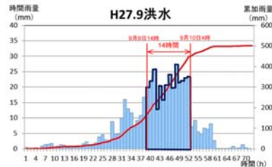
降雨の時間的変化（「鬼怒川の洪水被害及び復旧状況等について」関東地方整備局より）
